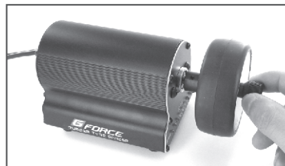
3. タイヤをセットし、ホイール固定スクリューを締め確実に固定します。
