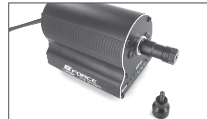
2. ホイール固定スクリューを外します。
